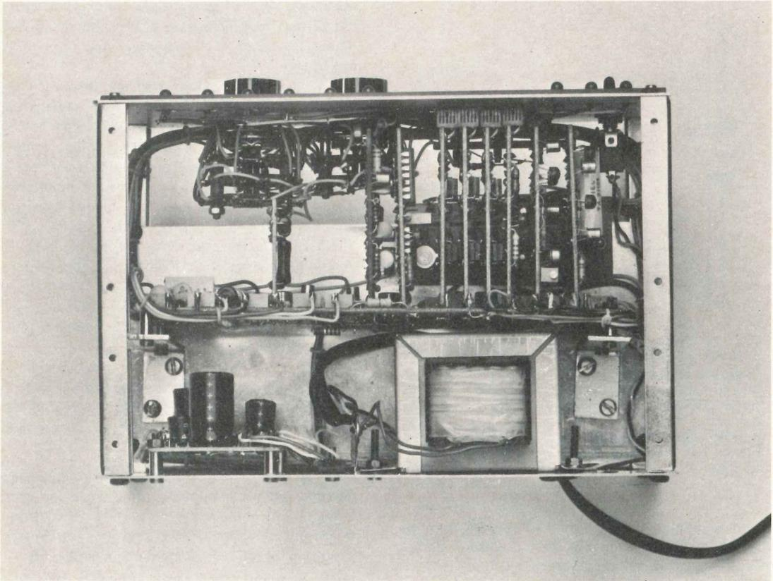
**Fig. 34** Foto del voltmetro completo di alimentatore e pronto per l'uso. Nel fissare il trasformatore di alimentazione, controllate che la calotta metallica di questo non venga a contatto con il circuito stampato dell'LX100. Eventualmente fissate sopra ad esso un ritaglio di nastro adesivo o altro spessore isolante.
