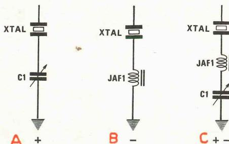
Fig. 1 Inserendo in serie ad un quarzo un compensatore da 30-60 pF. è possibile modificare leggermente la sua frequenza di risonanza (normalmente aumenta) mentre inserendo una induttanza o impedenza riusciremo a ridurla. Se come vedesi in fig. 1C applicheremo in serie una induttanza ed una capacità, potremo ritoccare tale frequenza in più o in meno a seconda che si agisca su JAF1 o C1.
