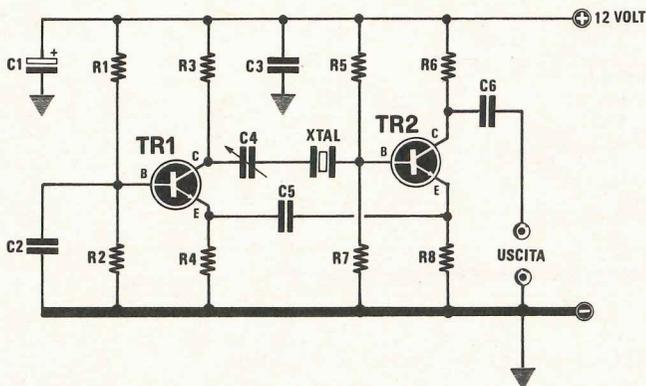
Fig. 5 OSCILLATORE IN FONDAMENTALE (0,5 MHz a 2 MHz)
