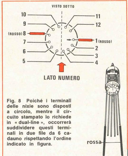
Fig. 8 Poiché i terminali delle nixie sono disposti a circolo, mentre il circuito stampato lo richiede in « dual-line », occorrerà suddividere questi terminali in due file da 6 ciascuna rispettando l'ordine indicato in figura.
