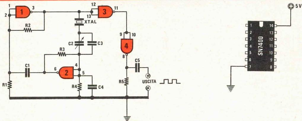
Fig. 3 OSCILLATORE CON INTEGRATO SN7400 (0,5 MHz a 10 MHz)
