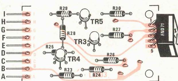
**Fig. 11** Schema pratico di montaggio relativo ai componenti presenti sul telaio LX.103. Per fissare sull'estremità frontale il display FND71 consigliamo il lettore di vedere la fig. 30.
