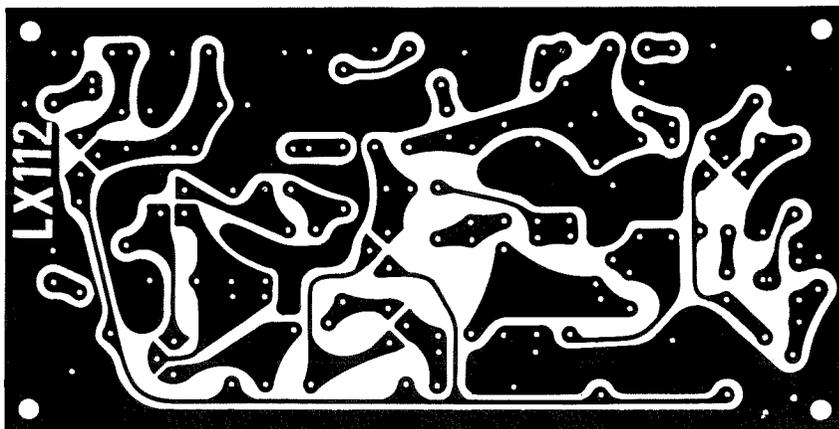
Fig. 4 Circuito stampato a grandezza naturale del preamplificatore-compressore LX.112.
