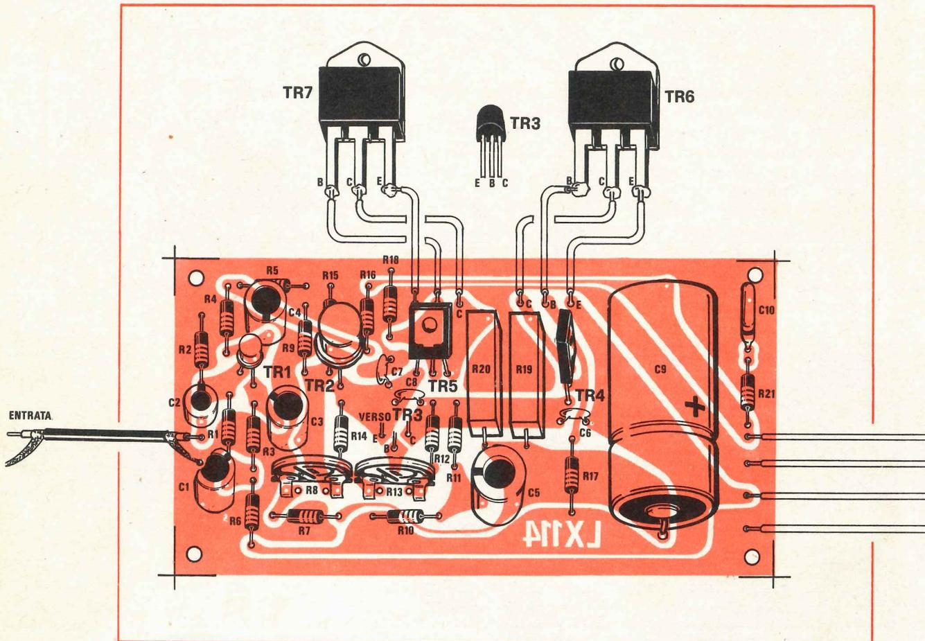
(consigliamo di isolare i terminali con un pezzettino di plastica in tubetto che potremo ricavare dall'isolante degli stessi fili per collegamento), onde evitare che, muovendo durante la fase di montaggio l'aletta di raffreddamento o il circuito stampato, si possa creare un cortocircuito tra questi tre terminali.
