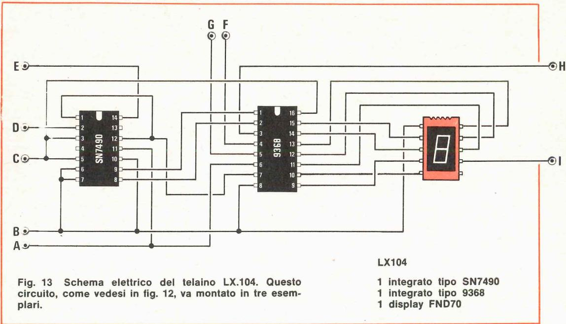
**Fig. 13** Schema elettrico del telaino LX.104. Questo circuito, come vedesi in fig. 12, va montato in tre esemplari.
