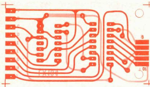
Fig. 14 Disegno a grandezza naturale del telaio LX.104. Questo circuito, essendo a doppia faccia, è necessario collegare, come vedesi in fig. 12 e 15, le piste inferiori con quelle superiori.
