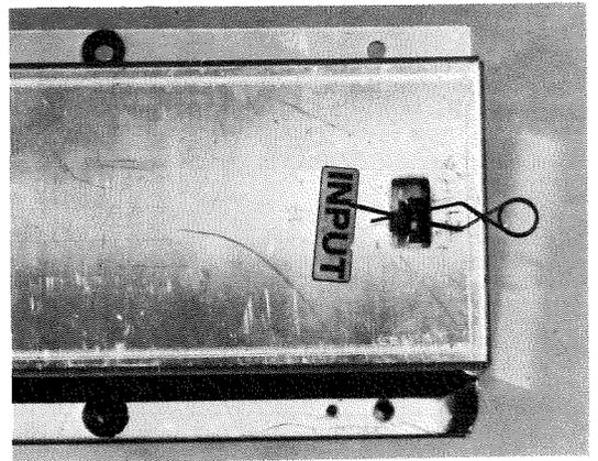
**Fig. 7** Nelle « unità » lunghe 42 cm (vedi fig. 6) sui due lati superiori dell'unità sono presenti due mollette di fermo che occorrerà togliere in quanto servono solo ed esclusivamente per non danneggiare le molle durante il trasporto.
