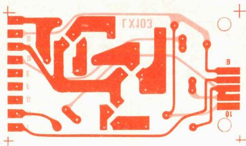
**Fig. 10** Circuito stampato a grandezza naturale e a doppia faccia del telaio LX.103. Su questo telaio andrà fissato il display FND71, quello cioè che dispone dei soli segni + - e del numero 1.
