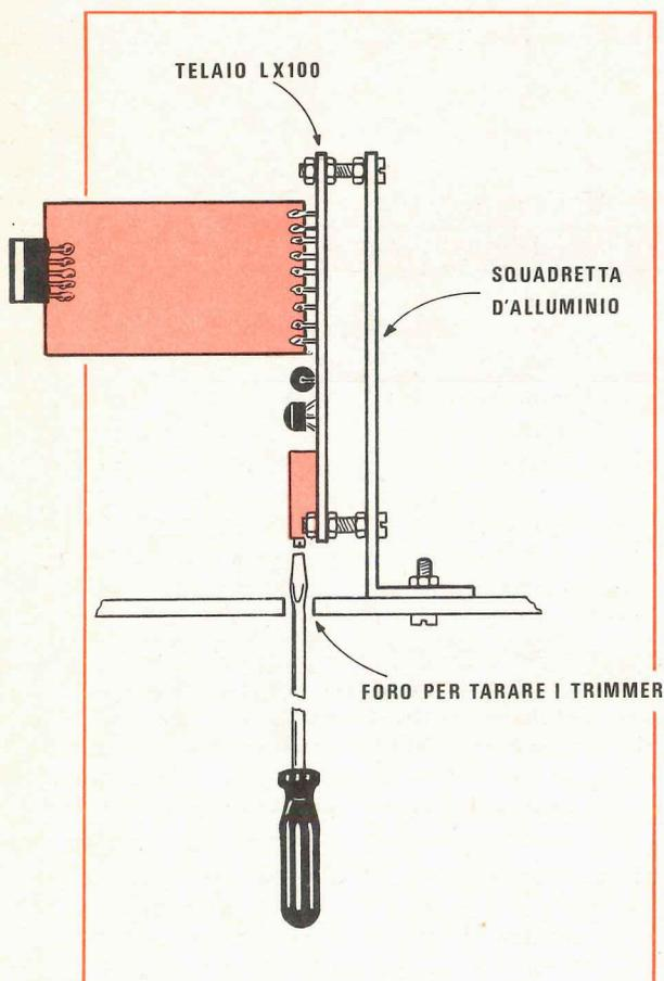
**Fig. 36** Prima di fissare stabilmente il telaio LX.100 sul piano metallico del telaio interno del mobile, praticate sotto ad esso un foro in corrispondenza dei vari trimmer multigiri, in modo da poterli regolare con un cacciavite senza doverlo smontare.
