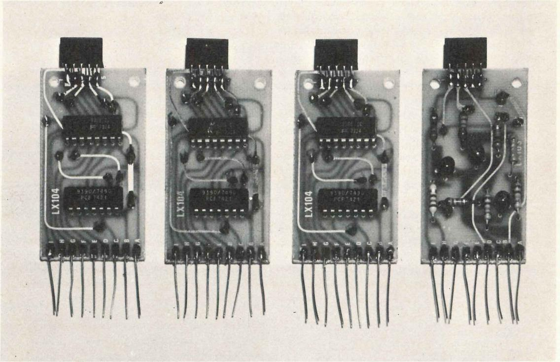
**Fig. 12** In questa foto sono visibili i tre telaini LX.104 completi del display FND70 più il telaio LX.103 (a destra) con il display FND71. Su questi telaini come spieghiamo nell'articolo non è possibile utilizzare per esigenze di spazio gli zocolini per gli integrati 9368 e SN7490.
