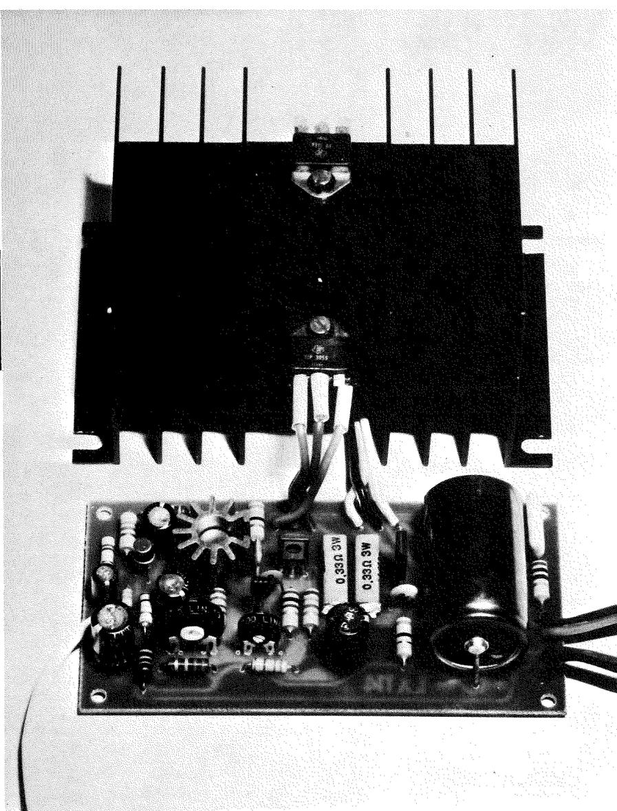
BD137 o BD139, mentre TR5 è un PNP al silicio tipo BD138 o BD140). Il transistor TR3 che troviamo collegato con il collettore e l'emettitore, tra le basi dei due pilota serve per stabilire tra di esse una differenza di potenziale, utile a compensare la «  $V_{be}$  » dei finali di potenza, per evitare distorsione da « cross-over ».
