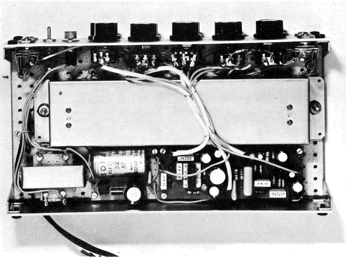
**Fig. 2** Utilizzando un'unità di riverbero da 24 cm la potremo inserirla, come vedasi in questa foto, direttamente nel mobile contenente il preamplificatore e alimentatore. Nel fissare l'unità di riverbero, cercate di non stringere troppo le viti, sui gommini passanti dei fori, in modo che il tutto rimanga molto fluttuante ed insensibile alle vibrazioni sonore che provengono dall'esterno.
