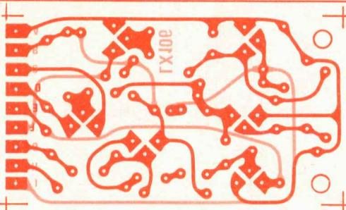
Fig. 20 Circuito stampato a doppia faccia del telaino LX106. Anche su tale circuito esistono molti ponticelli di collegamento tra pista inferiore e quella superiore.
