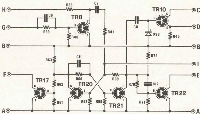
Fig. 19 Schema elettrico del circuito inserito nel telaino LX106.
