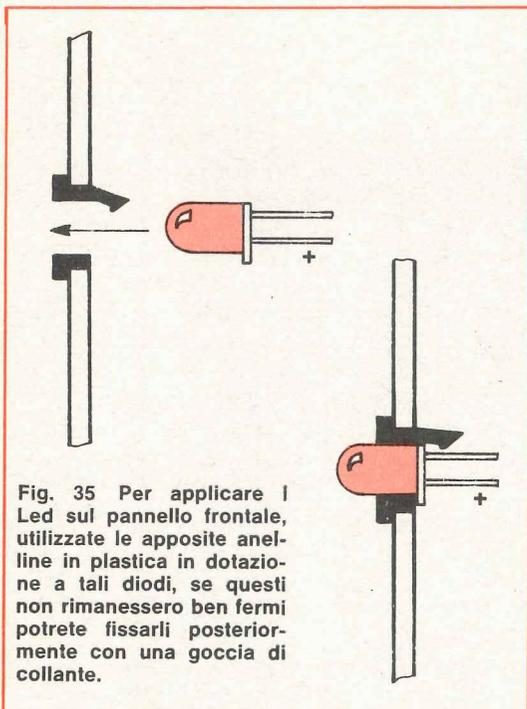
**Fig. 35** Per applicare i Led sul pannello frontale, utilizzate le apposite anel-line in plastica in dotazione a tali diodi, se questi non rimanessero ben fermi potrete fissarli posteriormente con una goccia di collante.
