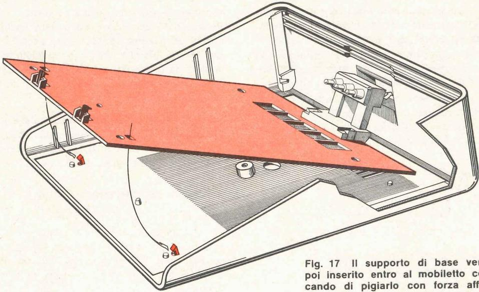
Fig. 17 Il supporto di base verrà poi inserito entro al mobiletto cercando di pigiarlo con forza affinché i ganci di fermo possano innestarsi e bloccarlo.
