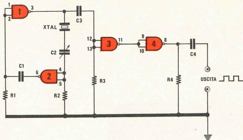
Fig. 2 OSCILLATORE CON INTEGRATO SN7400 (0,5 MHz a 10 MHz).
