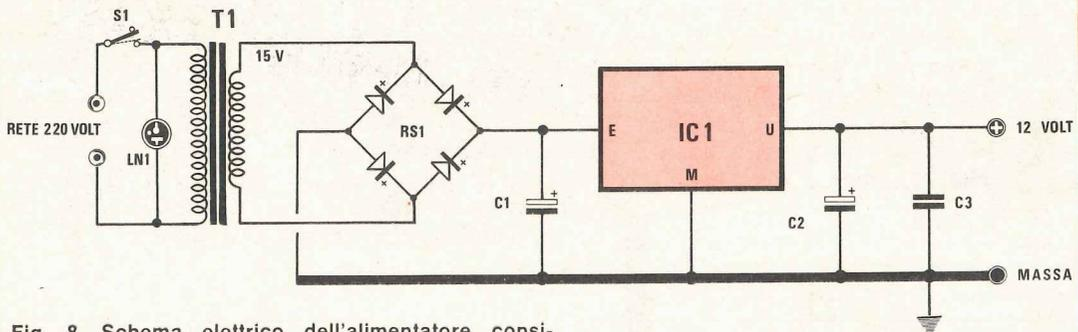
Fig. 8 Schema elettrico dell'alimentatore consigliato per questo progetto.
