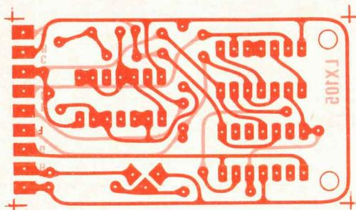
**Fig. 17** Circuito stampato a grandezza naturale del telaio LX.105. Ricordarsi di collegare le piste inferiori con quelle superiori nei punti indicati (vedi fig. 18).
