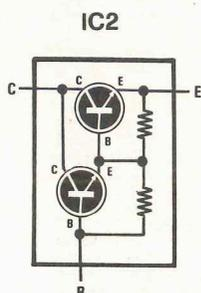
**Fig. 1.** Un transistor Darlington racchiude nel suo involucro, un transistor pilota più un finale di potenza e relative resistenze di polarizzazione. Attualmente esistono in commercio una vasta gamma di Darlington in grado di soddisfare come corrente e potenza ogni esigenza. L'alimentatore che vi proponiamo è stato realizzato per alimentare dei ricetrasmettitori di potenza.
