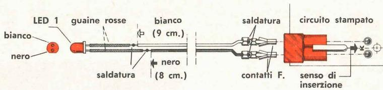
scaldare con il saldatore il contorno del foro e premere quest'ultimo per fissare il LED 1
