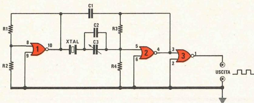
**Fig. 4 OSCILLATORE CON INTEGRATO SN7402 (0,5 MHz a 10 MHz)**
