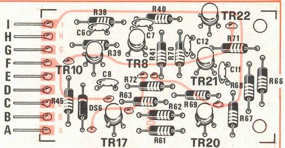
Fig. 21 Su tale circuito stampato per la moltitudine di componenti inseriti occorrerà fare attenzione per non inserire un transistor con i terminali E-B-C in posizione errata.
