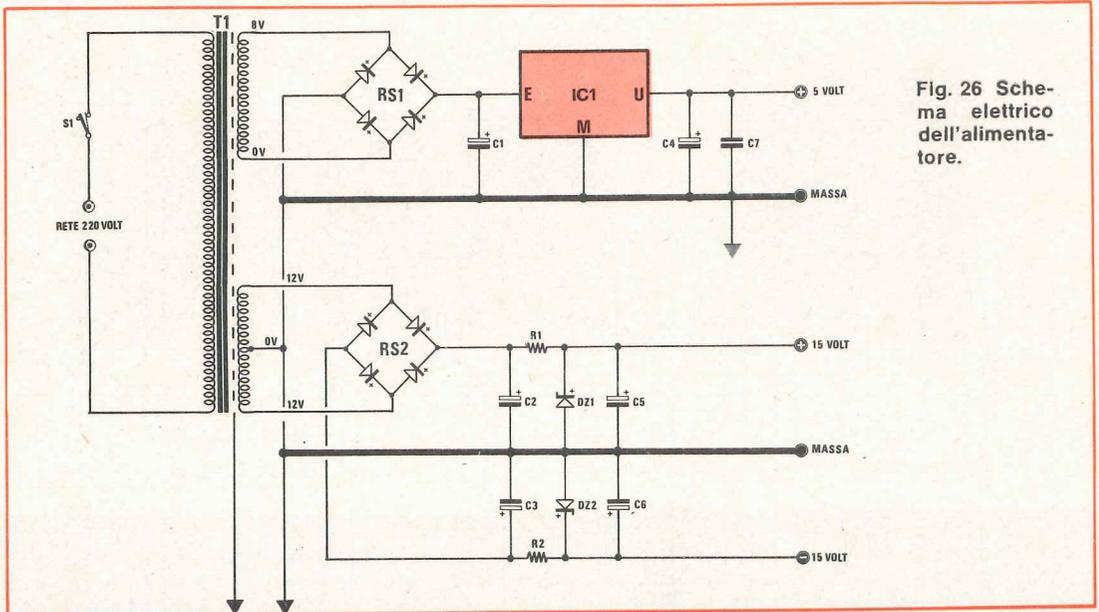
Fig. 26 Schema elettrico dell'alimentatore.
