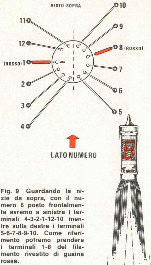
Fig. 9 Guardando la nixie da sopra, con il numero 8 posto frontalmente avremo a sinistra i terminali 4-3-2-1-12-10 mentre sulla destra i terminali 5-6-7-8-9-10. Come riferimento potremo prendere i terminali 1-8 del filamento rivestito di guaina rossa.
