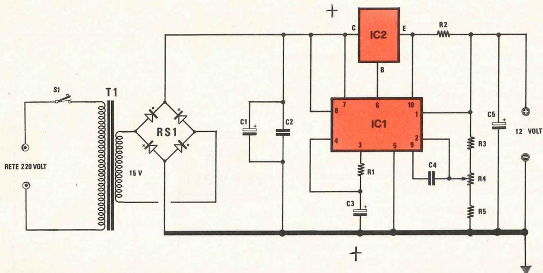
Fig. 4 Schema elettrico.
