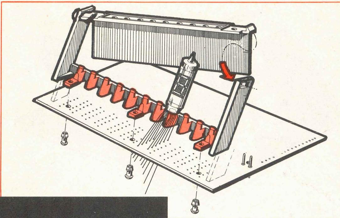
**Fig. 10** Suddivisi i terminali delle nixie come richiesto potremo infilarle nel circuito stampato, dopo che su di esso avremo già applicato il supporto di plastica visibile in disegno che è utile per tener distanziati le due file dei terminali, e per bloccare le nixie.
