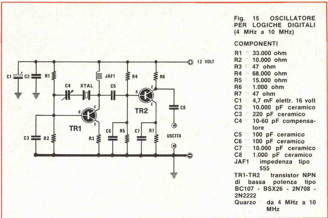
noi potremo far oscillare questo circuito su una frequenza doppia o tripla rispetto a quella fondamentale del quarzo variando semplicemente il solo circuito di sintonia L1/C4.
