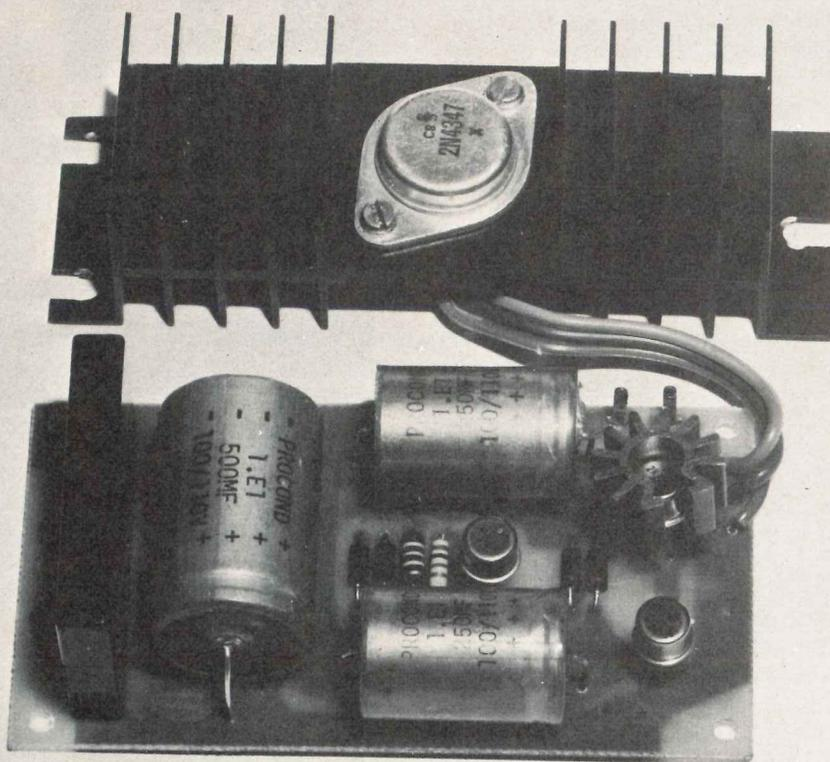
mentatore provvisto di un solo raddrizzatore e di un condensatore di livellamento dispone, la tensione erogata varia notevolmente, in funzione alla corrente assorbita.
