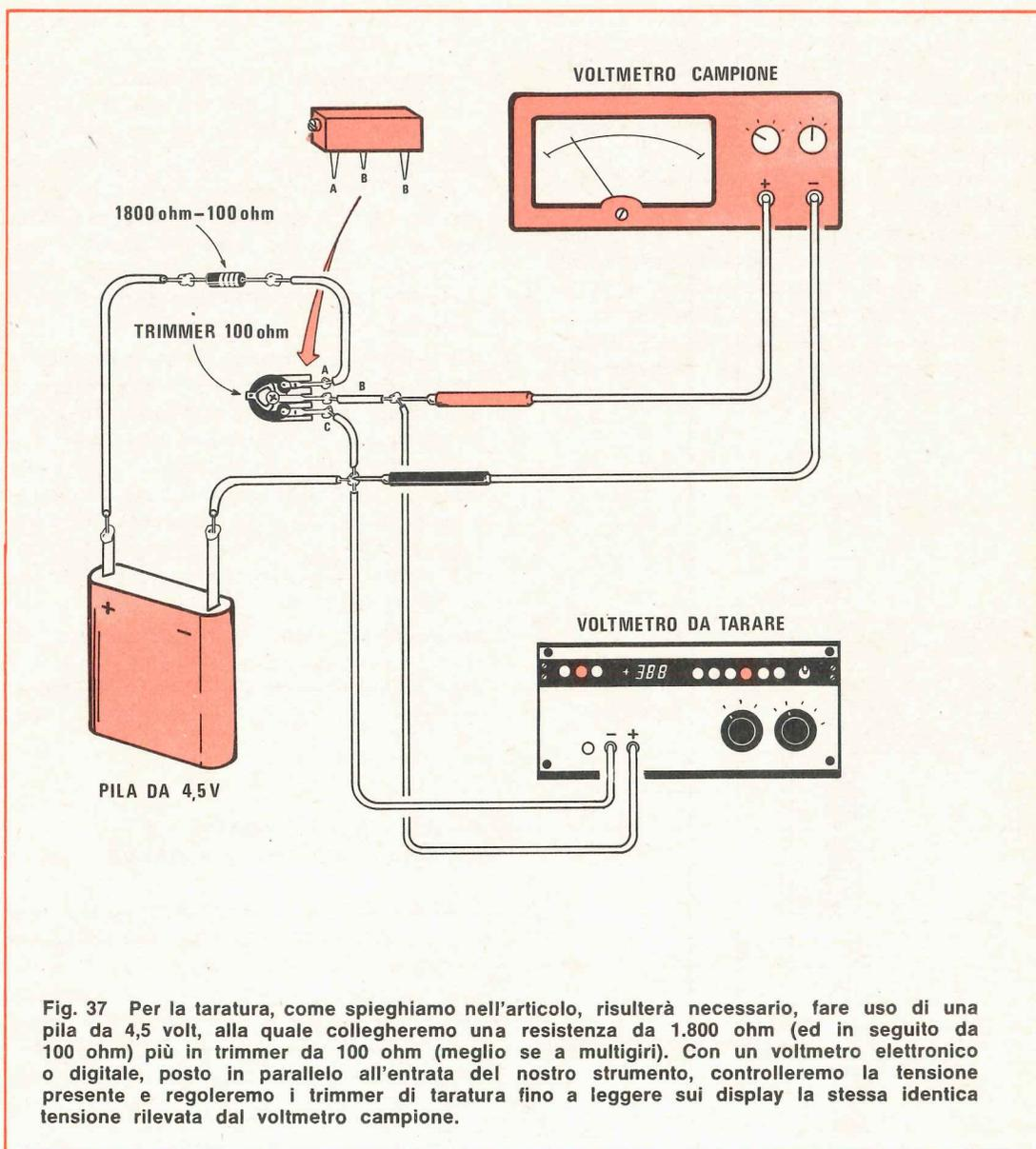
Fig. 37 Per la taratura, come spieghiamo nell'articolo, risulterà necessario, fare uso di una pila da 4,5 volt, alla quale collegheremo una resistenza da 1.800 ohm (ed in seguito da 100 ohm) più in trimmer da 100 ohm (meglio se a multigiri). Con un voltmetro elettronico o digitale, posto in parallelo all'entrata del nostro strumento, controlleremo la tensione presente e regoleremo i trimmer di taratura fino a leggere sui display la stessa identica tensione rilevata dal voltmetro campione.
