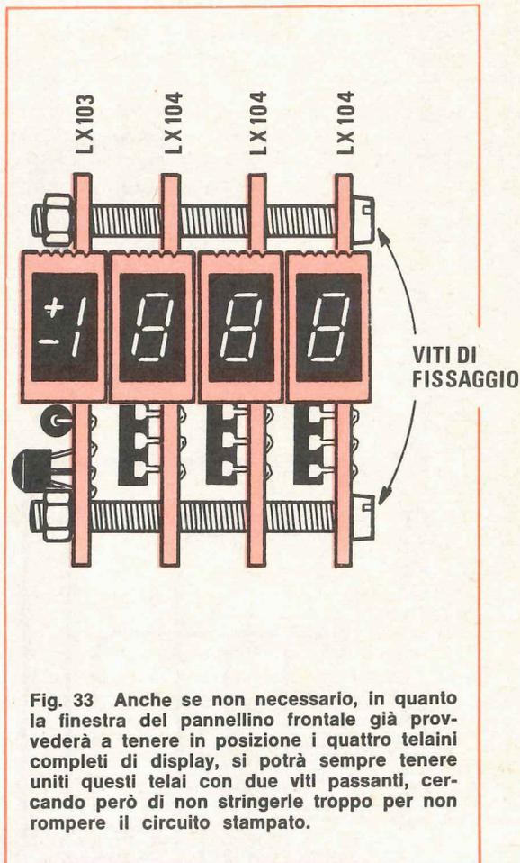
**Fig. 33** Anche se non necessario, in quanto la finestra del pannello frontale già provvederà a tenere in posizione i quattro telaini completi di display, si potrà sempre tenere uniti questi telai con due viti passanti, cercando però di non stringerle troppo per non rompere il circuito stampato.
