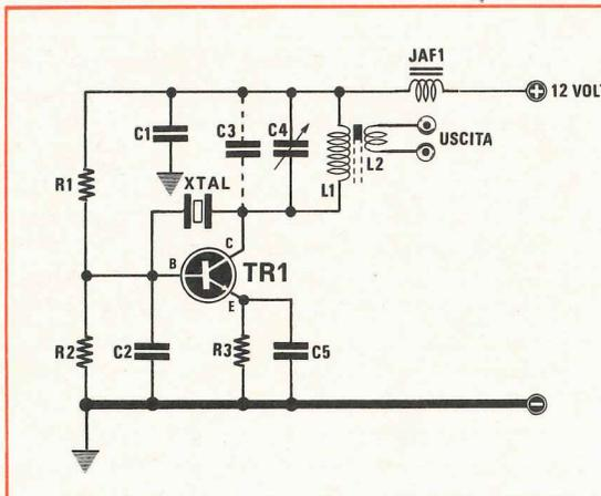
**Fig. 10 OSCILLATORE PER QUARZI OVERTONE (7 MHz a 100 MHz)**
