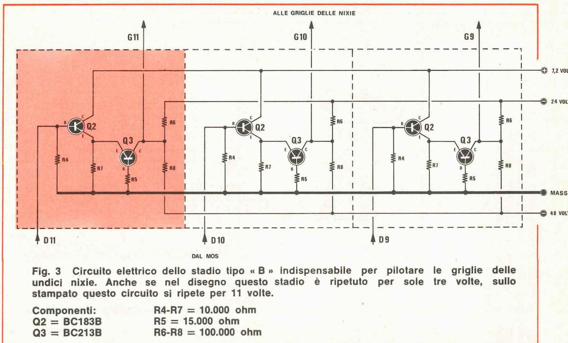
ecc., fino a D1, il segnale di pilotaggio per le basi dei transistor Q2 di ogni stadio, mentre dal collettore di Q3 preleveremo la tensione necessaria per pilotare le griglie delle nixie.
