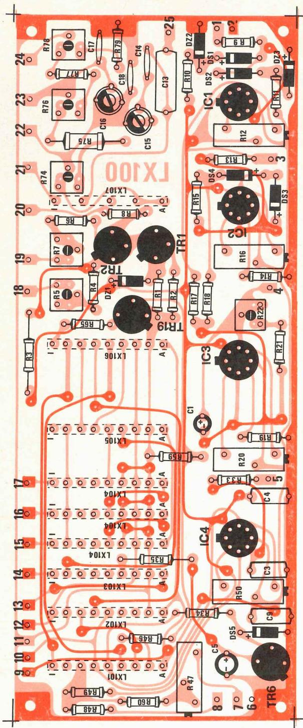
Fig. 2 Circuito stampato a doppia faccia del telaio LX.100 a grandezza naturale con sopra riportato il disegno serigrafico dei componenti.
