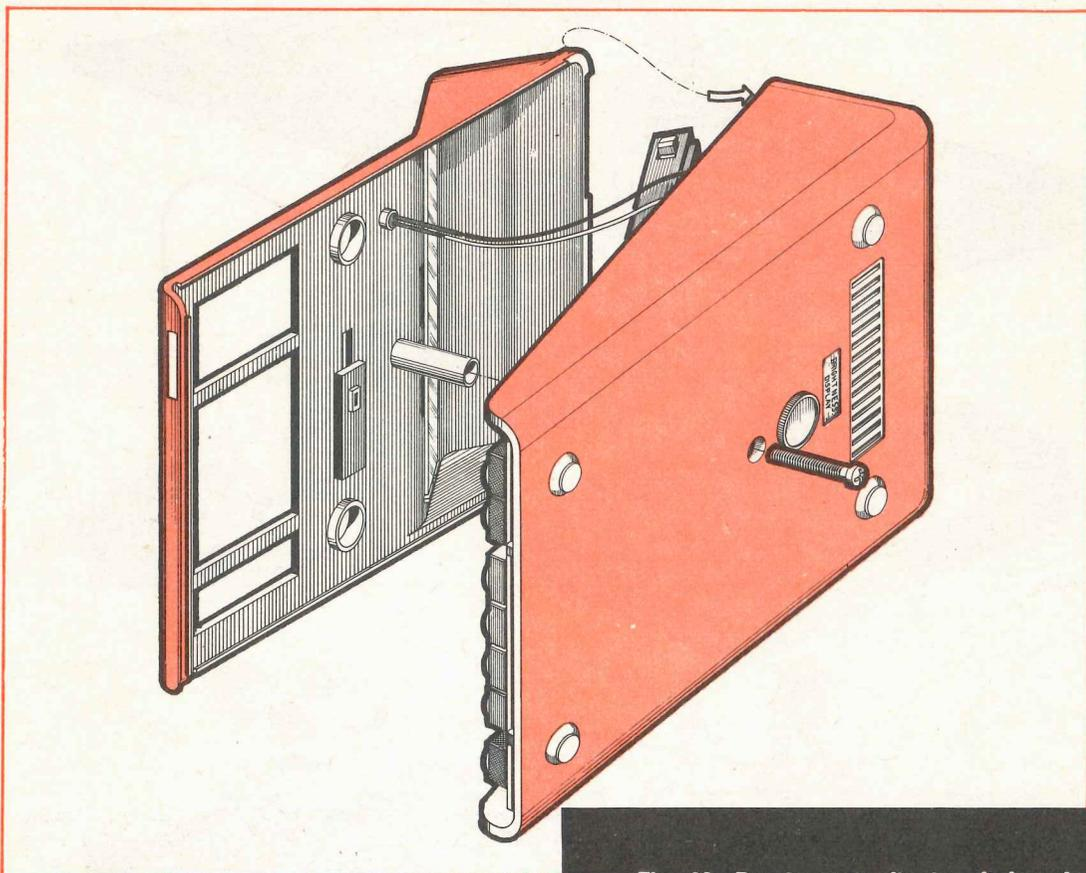
**Fig. 20** Per tenere unite tra di loro le due sezioni del mobiletto, si dovrà semplicemente infilare e stringere la vite entro al foro posto sulla parte posteriore del mobile. Questa operazione la eseguirete dopo che collaudata la calcolatrice avrete constatato che essa funziona correttamente.
