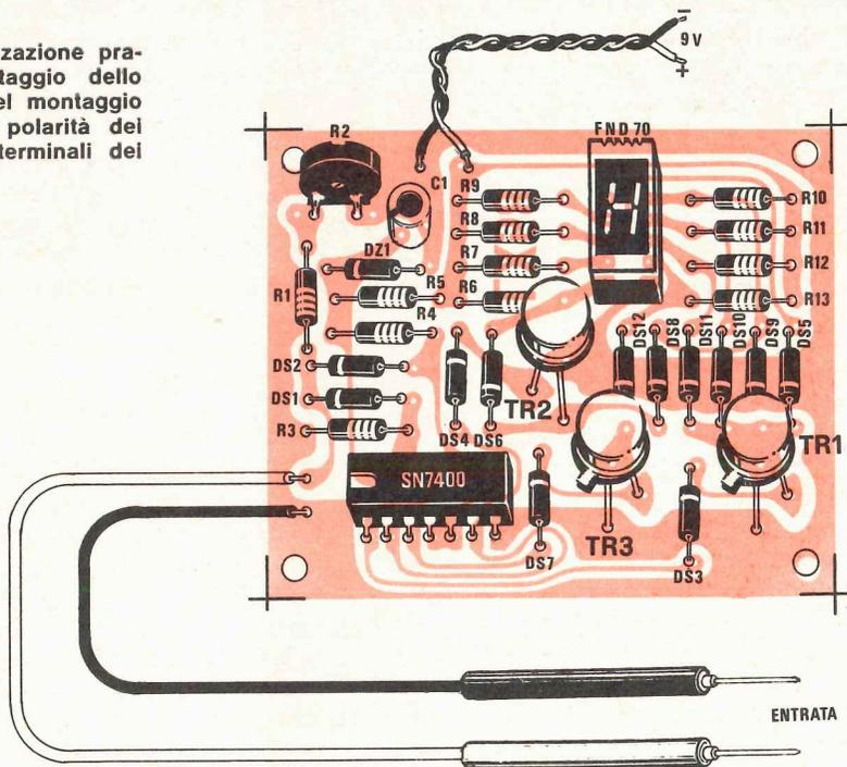
una condizione « H », cioè presenza di tensione. Questa, tramite il diodo DS7, polarizzerà la base di TR3 che, portandosi in conduzione, toglierà tensione al « punto » del display che pertanto rimarrà spento.
