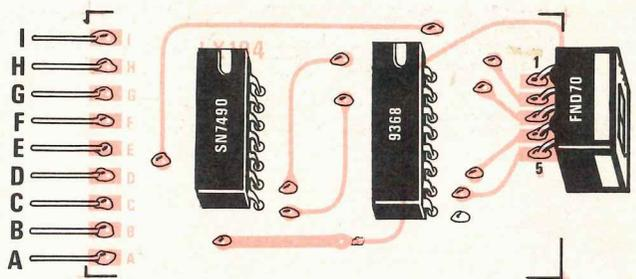
Fig. 15 Gli Integrati su tale telaio andranno inseriti con la tacca di riferimento disposta come vedesi in disegno. Per fissare il display FND70 consigliamo il lettore di adottare il sistema visibile in fig. 30.
