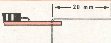
**Fig. 31** Sulle estremità dei telaini, dal LX.101 al LX.107, dovremo stagnarne come vedesi nelle figg. 3-12 degli spezconi di filo per poterli fissare al telaio principale.
