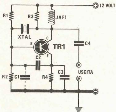
Fig. 12 OSCILLATORE IN FONDAMENTALE (4 MHz a 100 MHz)
