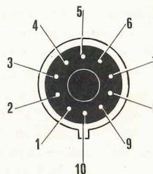
**Fig. 3 Connessioni dei terminali relativo all'integrato L.123 impiegato in questo circuito per pilotare il Darlington di potenza.**
