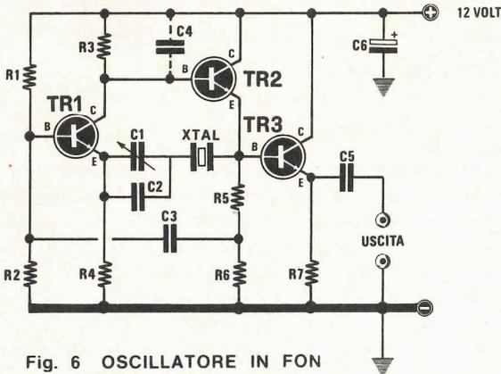
Fig. 6 OSCILLATORE IN FONDAMENTALE (0,5 MHz a 10 MHz)
