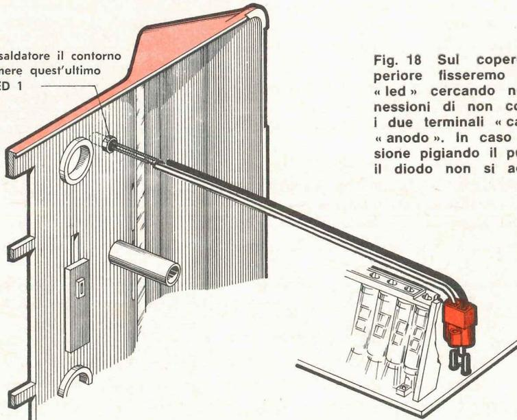
Fig. 18 Sul coperchio superiore fissiamo il diodo «led» cercando nelle connessioni di non confondere i due terminali «catodo» e «anodo». In caso di inversione pigiando il pulsante K il diodo non si accenderà.
