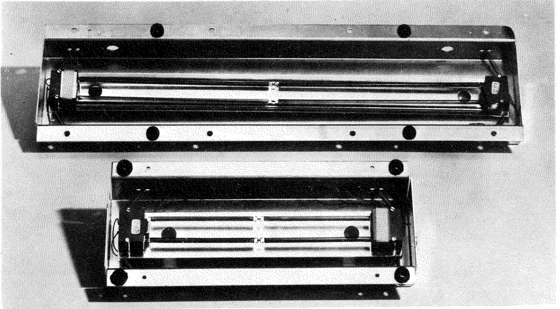
**Fig. 6** Il componente più importante di tutto il circuito è costituito dall'unità di riverbero. Se vi interessa raggiungere il massimo « effetto » scartate le unità di lunghezza inferiore ai 20 cm e quelle di tipo economico. Nella foto le due « unità » che si sono rivelate le più idonee come fedeltà di riproduzione ed « effetto ». L'unità maggiore è lunga 42 cm, quella minore 24 cm.
