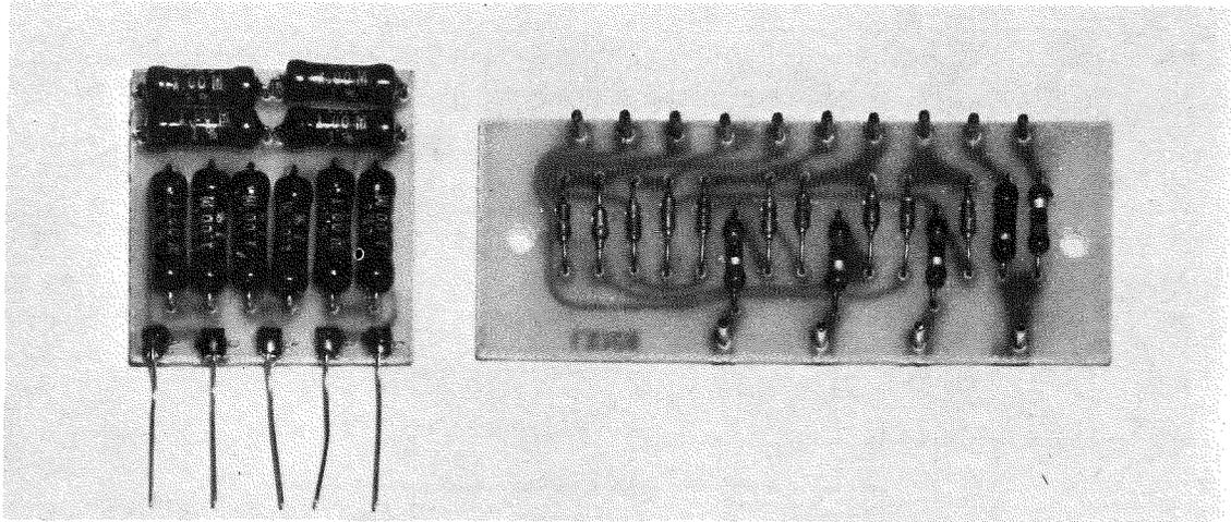
**Fig. 25** In questa foto possiamo vedere con i componenti già inseriti il telaio LX.107 e LX.108. Il primo telaio LX.107 troverà posto sul circuito stampato LX.100, mentre il secondo verrà fissato sul piano della scatola metallica nella posizione più idonea per effettuare i collegamenti con i diodi Led.
