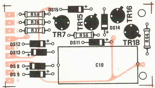
Fig. 6 Parte dello schema elettrico del voltmetro digitale montato sul telaio LX.102. Le lettere presenti sui terminali di tale schema servono, come per tutti i circuiti di questo voltmetro, a identificarne la posizione sui relativi circuiti stampati. (vedi figg. 7-8).
