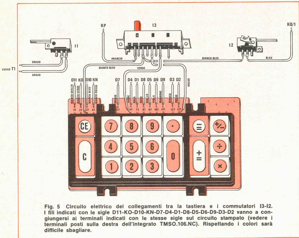
Fig. 5 Circuito elettrico dei collegamenti tra la tastiera e i commutatori I3-12. I fili indicati con le sigle D11-KO-D10-KN-D7-D4-D1-D8-D5-D6-D9-D3-D2 vanno a congiungersi ai terminali indicati con le stesse sigle sul circuito stampato (vedere i terminali posti sulla destra dell'integrato TMSO.106.NC). Rispettando i colori sarà difficile sbagliare.
